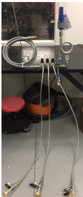
FIGURE 5: Équipement du collecteur de chargement rapide
