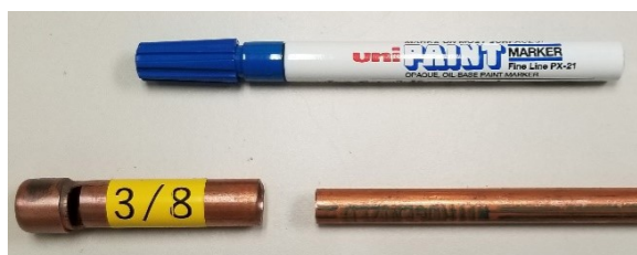
FIGURE 24: Outil de marquage de tube et marqueur de peinture
